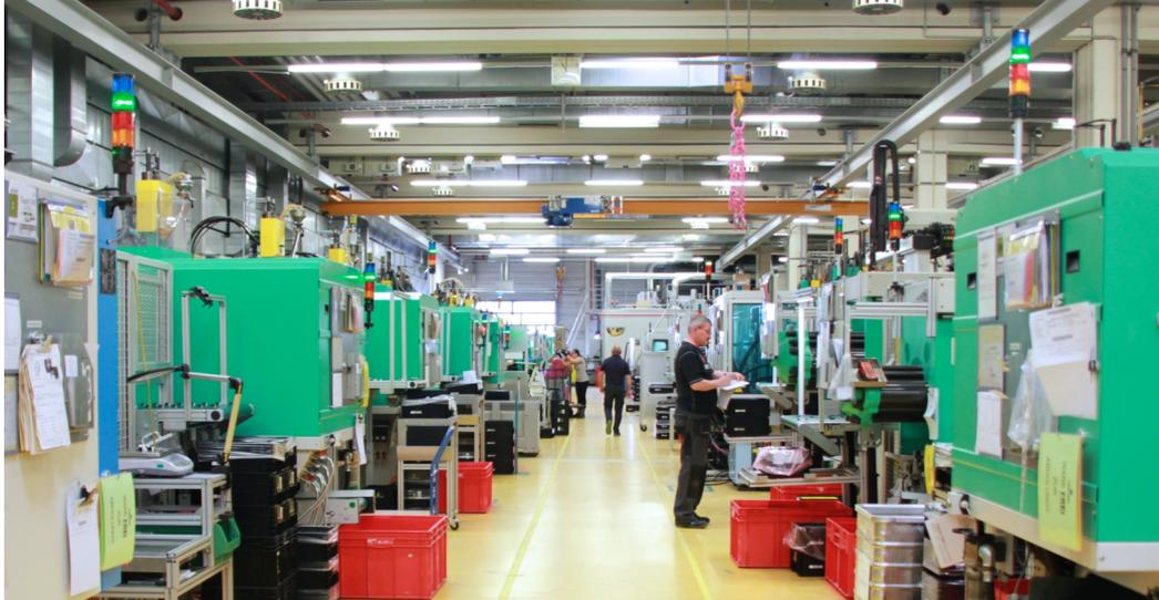
Über 100 Spritzgießmaschinen sind bei der Firma Marquardt mit dem MDE-System „WIN“ ausgestattet. Der Automobilzulieferer steigert damit seine Produktivität um hervorragende 10% und sichert sich langfristig seine Wettbewerbsfähigkeit.
